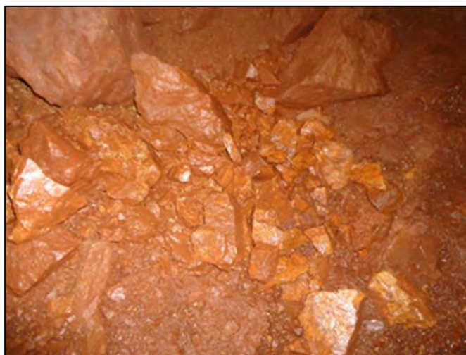
Εικόνα 4. Η μεταλλοφορία Βωξίτη στο μέτωπο εξόρυξης.
