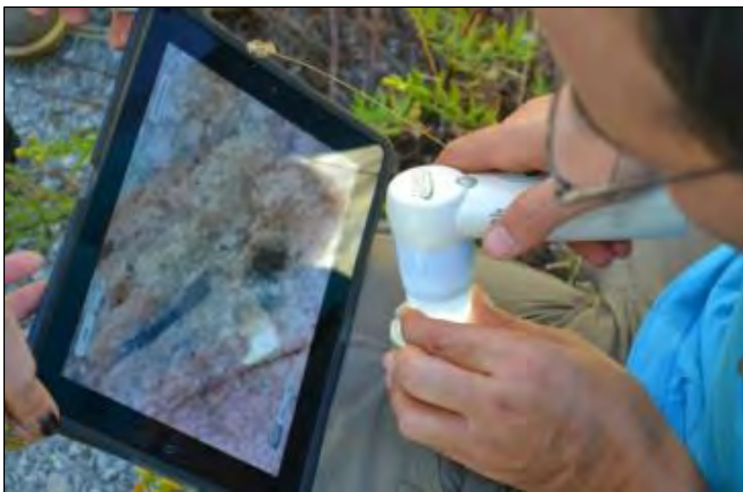
Εικόνα 7 Χρήση ασύρματου φορητού μικροσκοπίου τύπου mobile Proscope συζευγμένου με tablet για την ιστολογική και μικροσκοπική παρατήρηση δειγμάτων χειρός επί τόπου. Διακρίνεται κρύσταλλος γλαυκοφανή στην εικόνα του tablet (Φωτογραφία από αρχείο Καρανίκα Κ.)
