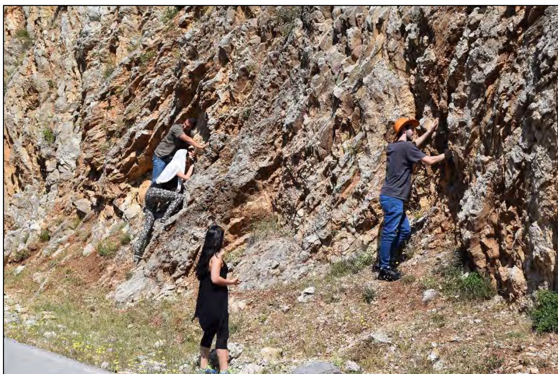
Εικ. 4. Φοιτητές μετρούν με τη γεωλογική πυξίδα τεκτονικές δομές σε ασβεστολιθικούς σχηματισμούς της ζώνης Πίνδου.
