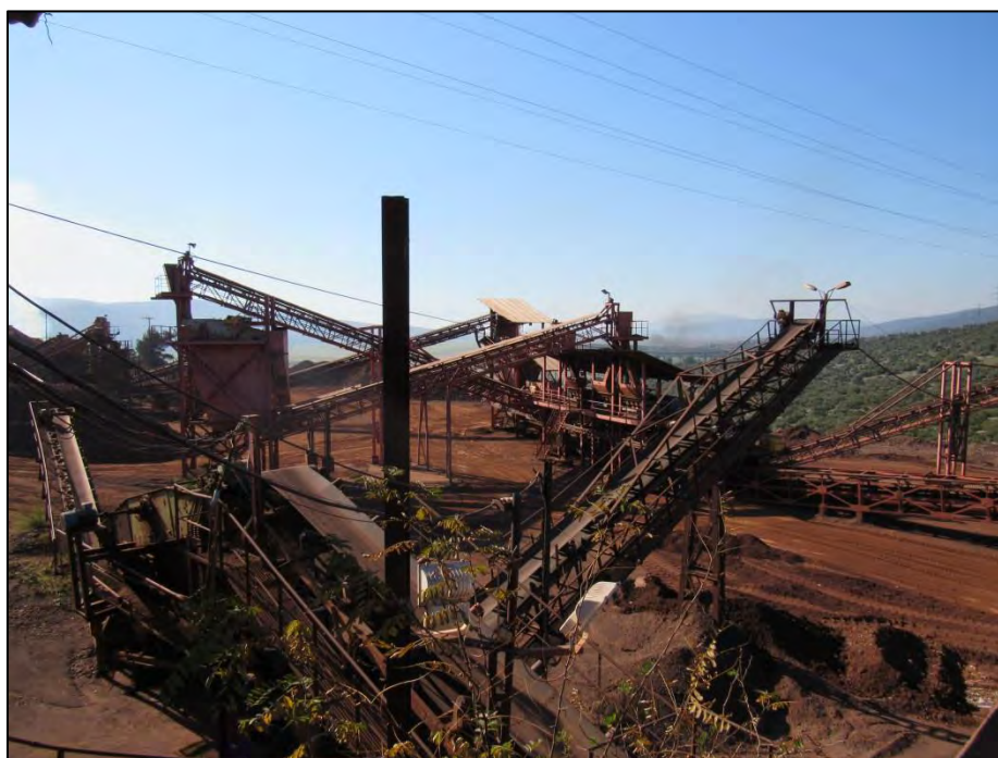
Εικόνα 6. Μονάδα εμπλουτισμού του Fe-Ni-ούχου μεταλλεύματος.
